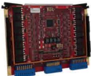
**DDC**, una empresa especializada en la producción de controladores de potencia (SSPCs), entre otros y representada por **Donalba** en toda la península ibérica, ha diseñado el controlador de potencia en estado sólido **RP-28001000NO MIL-STD-704F** de 270 V CC, 150 A y 12 canales.
