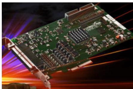
Por último, un FPGA da acceso a procesamiento de datos y control y ofrece la posibilidad de expandir las funciones de procesamiento de datos para aplicaciones personalizadas.
