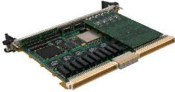
**Curtiss-Wright**, empresa representada por **Donalba** en toda la Península Ibérica, ha diseñado un switch Ethernet Gigabit equipado con todas las funciones necesarias para proporcionar una solución red completa en sistemas VME. Este switch se conoce como **VME-690**.
